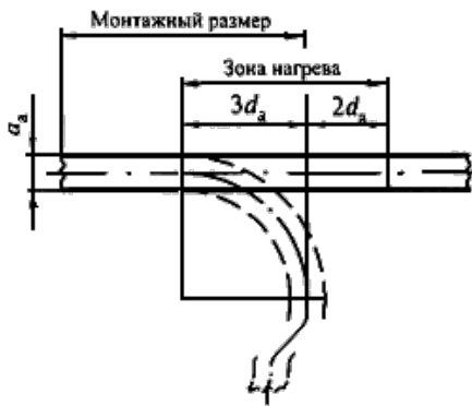
Рисунок 14 - Определение зоны гибки и зоны нагрева перед гибкой для исполнения дуги под углом 90°
